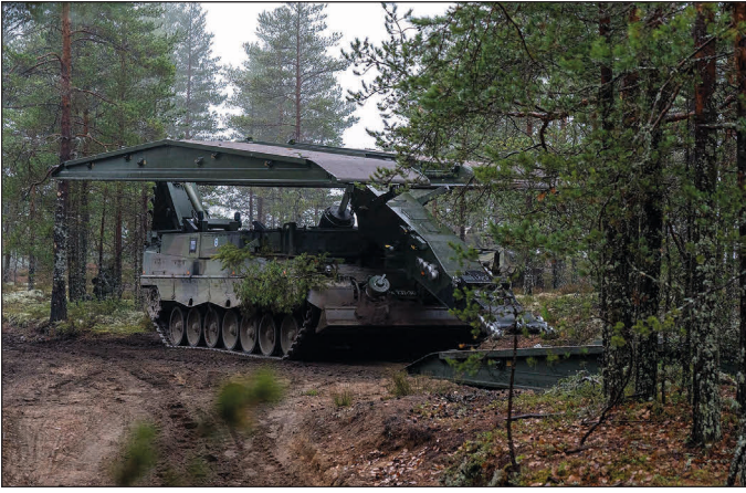
Leopard 2L laskenut uuden 14 metrin sillan. Toinen silta vielä vaunun kyydissä.
