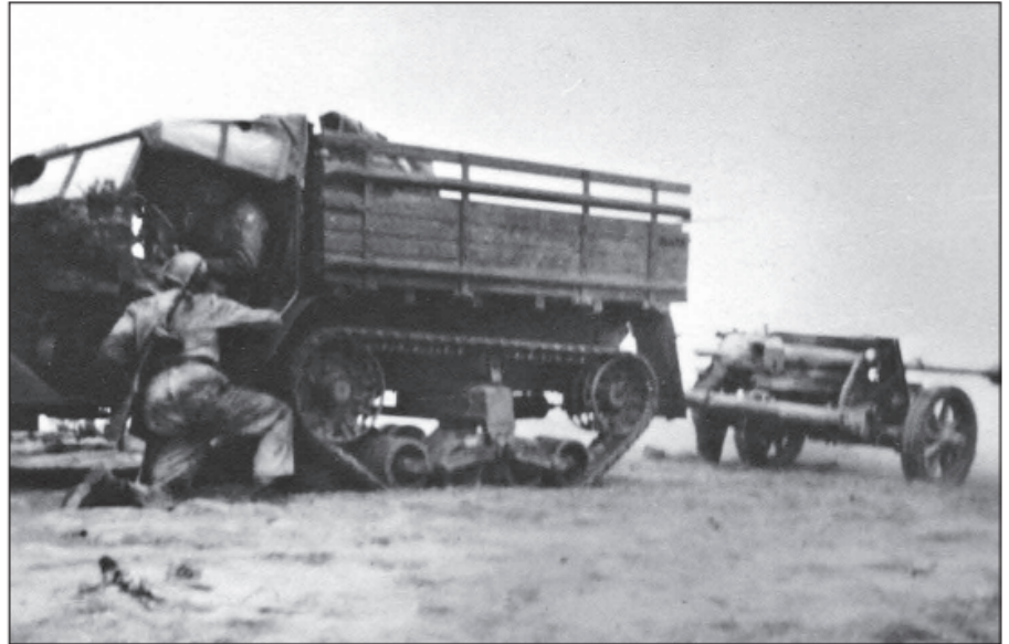
White-puolitela-auton perässä kiinni oleva 75 K/40-pst-tykki on juuri lau- kaistu. Huomaa peräytynyt tykin putki sekä lukosta ulos lentävä hylsy.
